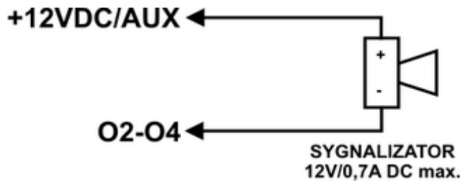
14 Przykład podłączenia sygnalizatora (obciążenia) do wyjść O2 - O4.
